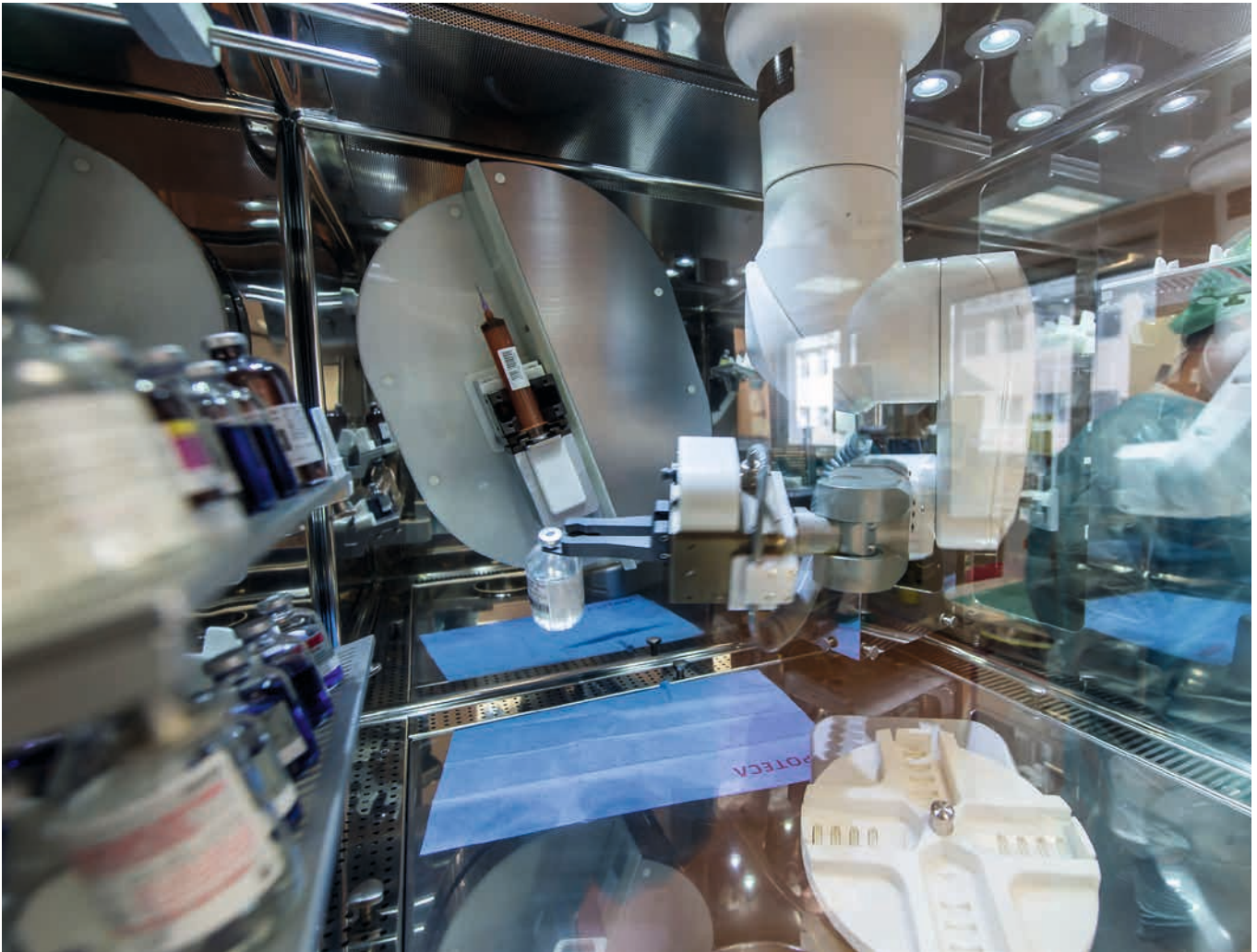
Dieser Roboter zur sterilen Herstellung von Chemotherapie-Lösungen wurde in Bozen entwickelt und wird mittlerweile weltweit eingesetzt
